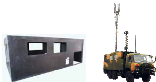
III型舱体：5000mm×2470mm×1900mm，重量 440kg，与传统方舱相比减重 50%。
