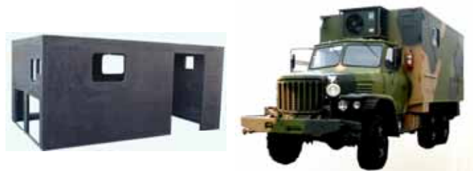
II 型舱体：4012mm×2438mm×1930mm，重量 380kg，与传统方舱相比减重 50%。
