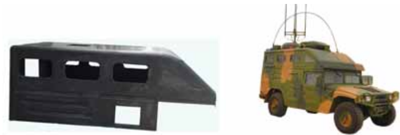
I 型舱体：2500mm×2130mm×1270mm，重量 170kg，与传统方舱相比减重 65%。
