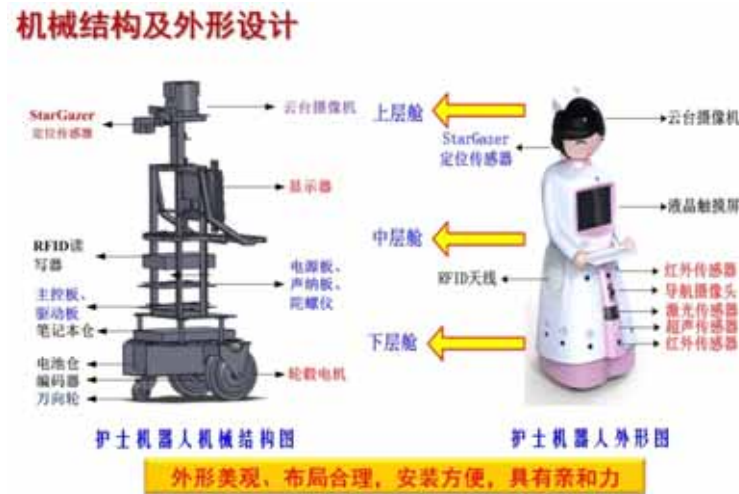
图 1 巡视机器人机械结构和外形设计
